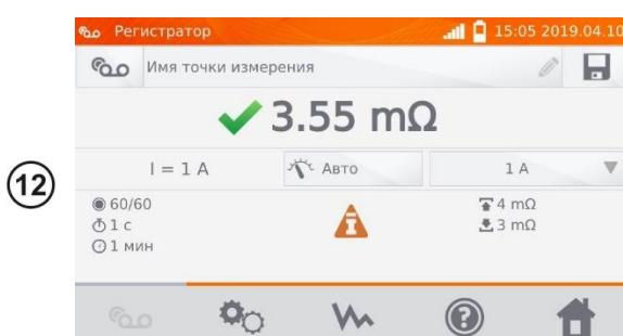
Дисплей отобразит результат измерения и количество записанных точек измерения.
