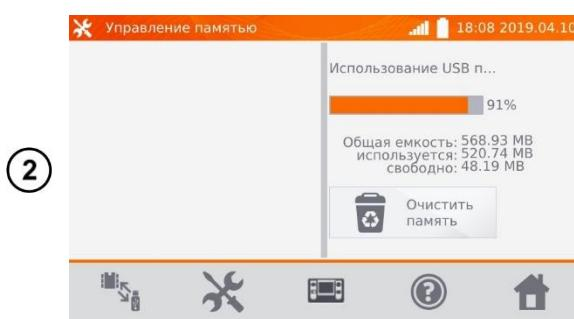
Установите Flash-накопитель в соответствующий USB разъём измерителя.
