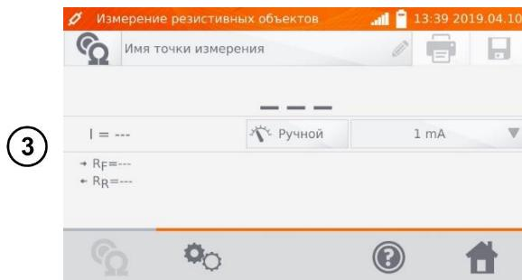
Переключение типа регулирования измерительного тока **Авто/Ручной**
