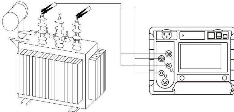
Подключите измеритель к обмотке трансформатора.
