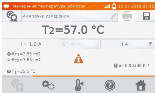
По истечении времени работы выключите электродвигатель и подключите измеритель к обмотке двигателя.
