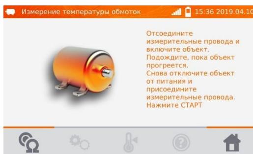
Отсоедините измерительные провода от электродвигателя и запустите двигатель.
