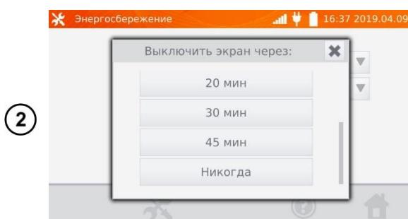
Установите время до выключения экрана дисплея и выключения измерителя...
