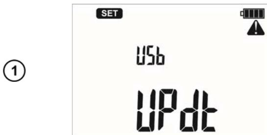
Когда измеритель определит USB соединение, следуйте инструкциям программы.
