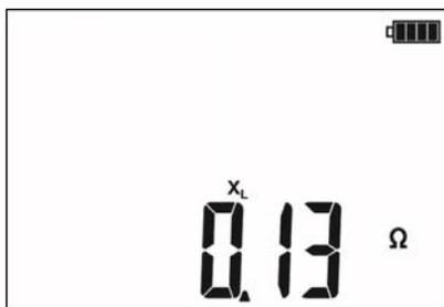
**X<sub>L</sub>** реактивное сопротивление петли короткого замыкания.
