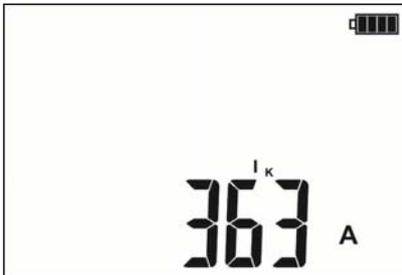
**I<sub>k</sub>** ток петли короткого замыкания или
