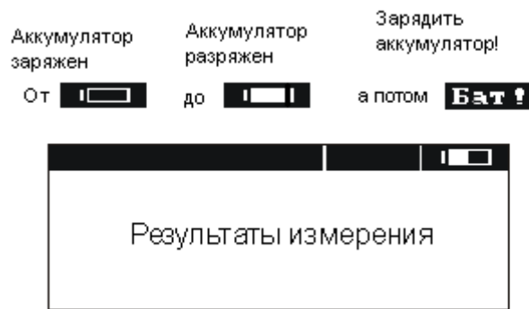
Контроль состояния зарядки аккумуляторов
