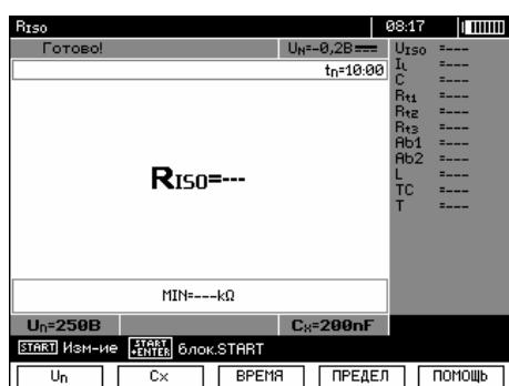
Для того чтобы изменить измерительное напряжение нажмите клавишу F1  $U_h$ .
