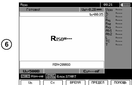
Прибор готов к измерению. На дисплее можно прочитать значение напряжения помех.
