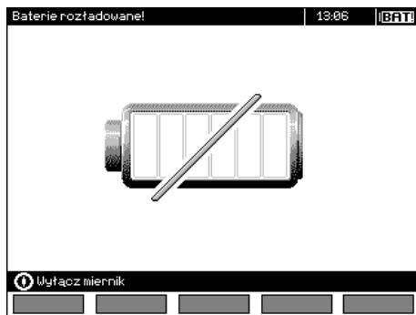
Аккумулятор разряжен, все измерения блокируются.
