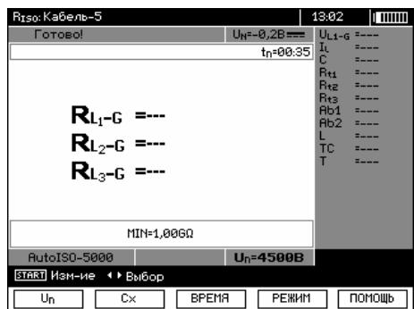
Прибор готов к измерению. На дисплее можно прочитать значение напряжения помех.
