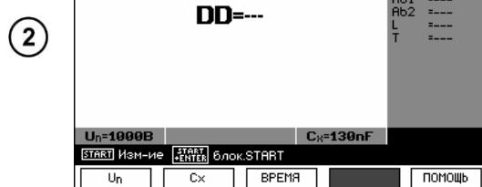
С помощью клавиш **F1** **Un**, **F2** **Cx** и **F3** **ВРЕМЯ** установите испытательное напряжение, ёмкость объекта и время измерения (1мин...60мин) согласно п.3.2.1.
