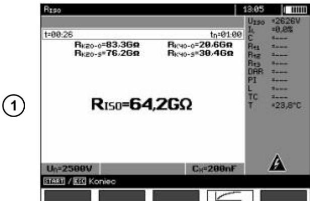
$R_{k20-0} - R_{ISO}$  преобразуется в значение при 20 °C для масляной изоляции (например, маслонаполненные КЛ).
