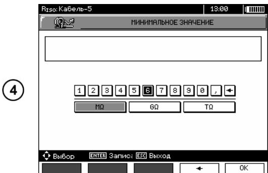
Нажатием клавиши **F4 ПРЕДЕЛ** перейдите к установке значения минимального сопротивления. Оно будет одинаковым для всех пар жил провода или кабеля.
