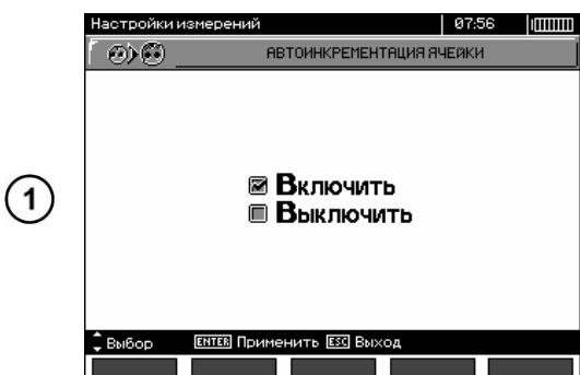
Клавишами  $\uparrow$   $\downarrow$  выберите включение или выключение функции автоматического изменения номера ячейки памяти (автоматически изменяется номер на порядок (+1), при добавлении данных в память прибора). Клавишей **ENTER** подтвердите свой выбор.
