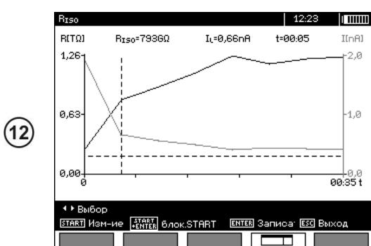
Результат в виде графика. Горизонтальная пунктирная линия показывает значение установленного лимита. С помощью клавиш  $\leftarrow \rightarrow$  перемещается линия курсора (вертикальная пунктирная линия) и на дисплее отображаются данные для точки измерения  $R_{ISO}$ ,  $I_L$  и времени.
