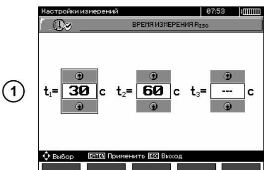
Клавишами  $\leftarrow$   $\rightarrow$  происходит переход к очередному интервалу, а клавишами  $\uparrow$   $\downarrow$  устанавливается значение времени. Клавишей **ENTER** подтвердите свой выбор. Выбор из диапазона:  $t_1$  (1...600 сек.),  $t_2$  (1...600 сек.,  $t_2 > t_1$ ),  $t_3$  (1...600 сек.,  $t_3 > t_2$ ).
