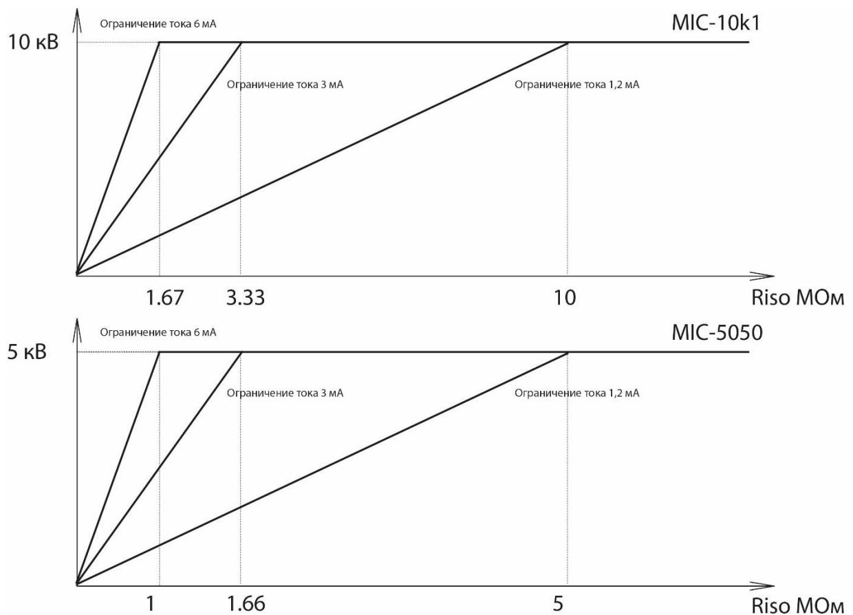
Фактическое измерительное напряжение для функции измерения сопротивления изоляции  $R_{ISO}$
