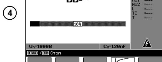
Как во время измерения, так и после его завершения существует возможность переключения между экраном с результатами и экраном с графиком с помощью клавиши **F4** .
