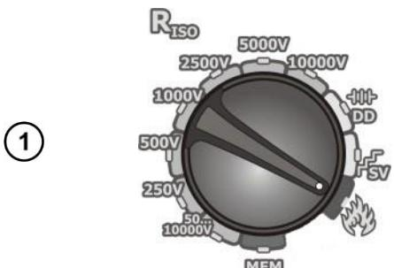
Установите поворотный переключатель выбора функций в положение . Прибор находится в режиме измерения напряжения.
