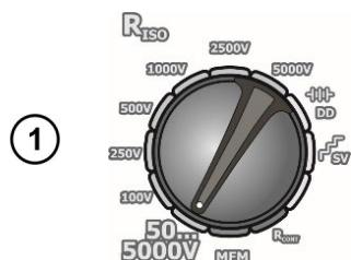
Установите поворотный переключатель режимов работы в одну из позиций **R<sub>ISO</sub>**, выберите измерительное напряжение (в положении **50...5000В** выбирается из диапазонов: 50 ... 1 кВ через каждые 10 В, 1 ... 5 кВ с шагом 25 В). Прибор находится в режиме измерения напряжения.
