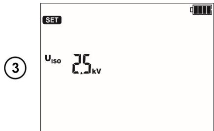
Максимальное (окончательное) измерительное напряжение:
