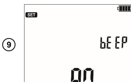
(9) Включение (ON) и отключение (OFF) звуковых сигналов.
