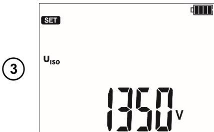
Измерительное напряжение **U<sub>ISO</sub>**.
