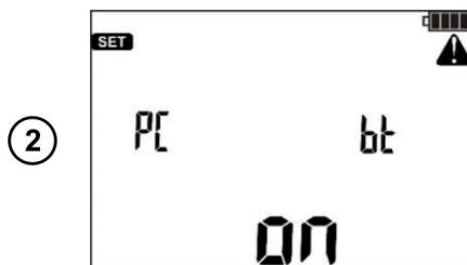
Подключите модуль Bluetooth к USB разъёму персонального компьютера, нажмите клавишу **ENTER**.
