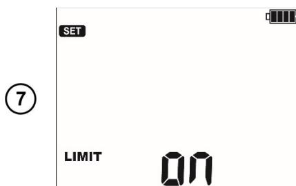
(7) Включение (ON) и выключение (OFF) установки пределов измерения (только **MIC-5010**).
