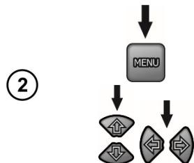
Нажимая клавишу **MENU** можно перейти к выбору времени для расчёта коэффициентов абсорбции ( $t_1$ ,  $t_2$ ,  $t_3$ ) и общему времени измерения  $t_n$ , тока  $I_{SC}$  и  $limit$  (только **MIC-5010**).
