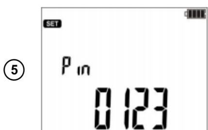
(5) PIN-код, устанавливаемая цифра мигает. Переход к следующей цифре клавишами **F3** и **F4**.
