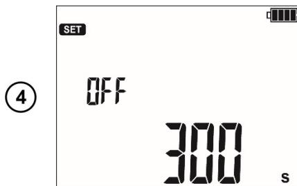
(4) Время до автоматического выключения (300 сек., 600 сек., 900 сек.) или его отсутствие (----).
