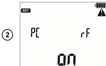
② Подключите модуль OR-1 к USB разъёму персонального компьютера, нажмите клавишу **ENTER**.
