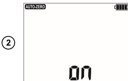
На дисплее появится надпись **AUTO-ZERO 0Ω** свидетельствующая о выполнении калибровки измерительных проводов, затем прибор переходит в режим измерения.
