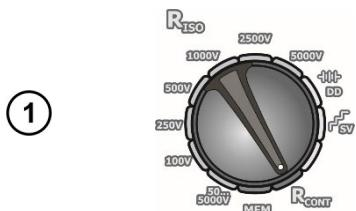
Установите поворотный переключатель выбора функций в положение **R<sub>CONT</sub>**.
