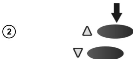
Используя клавиши  $\Delta$  и  $\nabla$ , установите значение времени до автовыключения прибора **OFF** или отключите данную функцию.
