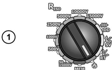
Поворотный переключатель выбора функций установить в положение **Дожигание**.
