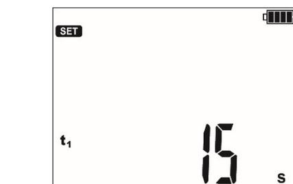
Установка времени  $t_1...t_3$ .
