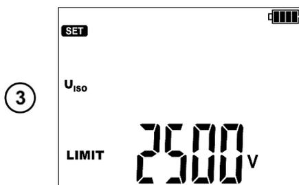
Окончательное напряжение измерения  $U_{iso}$  **LIMIT**.
