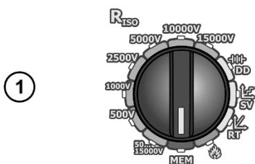
Установите поворотный переключатель выбора функций в положение **MEM** и нажмите на клавишу **MENU**.
