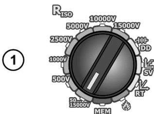
Установите поворотный переключатель режимов работы в одну из позиций  $R_{ISO}$ , выберите измерительное напряжение (в положении **50...15000V** выбирается с шагом в 10 В).
