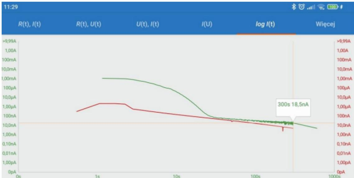
Если форма кривых близка, это означает, что состояние исследуемого объекта хорошее. Если кривые выступают друг от друга, это может означать ухудшение изоляции. Ее степень можно определить по тому, насколько велика разница между кривыми, а по характеру – по тому, в какой момент измерения эта разница произошла.
