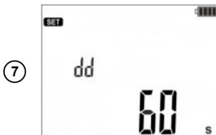
Настройка времени измерения тока утечки для функции **DD**.
