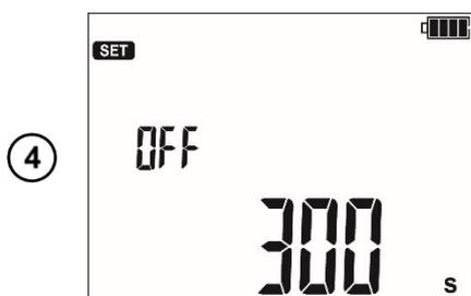
Время до автоматического выключения (300 сек., 600 сек., 900 сек.) или его отсутствие (- - - -).
