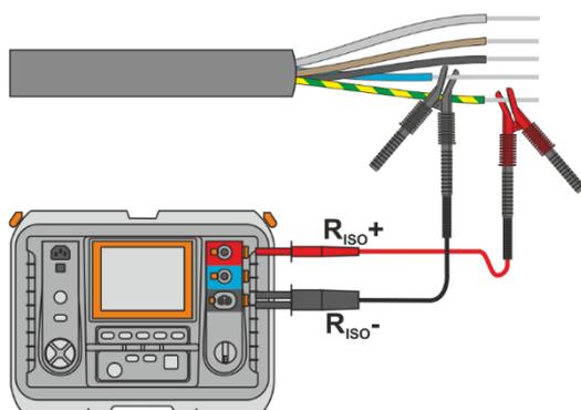
Подключите измерительные провода согласно рисунку.
