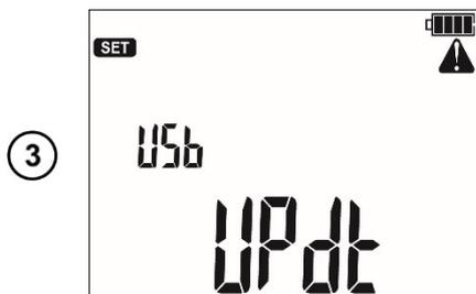
Подключить измеритель к компьютеру с помощью кабеля USB и нажмите **ENTER**.
