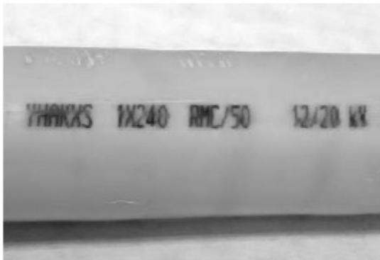
Маркировка на кабельной продукции состоит:
