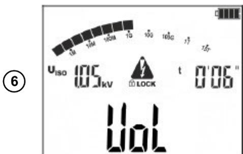
На втором этапе измеряется поперечное сопротивление  $R_{vol}$ .
