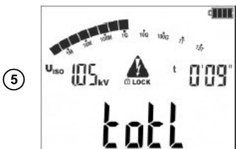
При первом этапе измеряется суммарное сопротивление изолятора  $R_{totl}$ .
