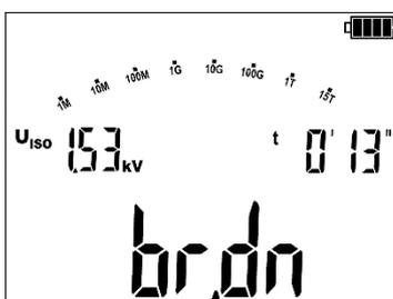
Если в процессе нарастания напряжения произойдет пробой изоляции, то измеритель отобразит:
