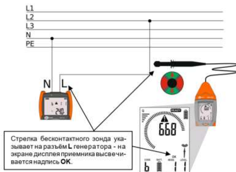
Идентификация разъёма L генератора
