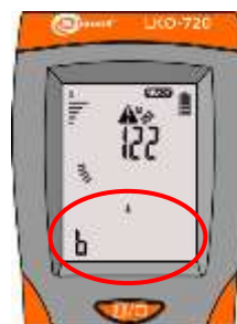
Устройства не синхронизированы: отсутствует информация о состоянии работы генератора.
