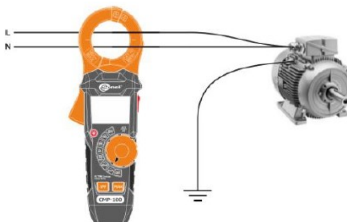
Измерение тока утечки – косвенный метод
